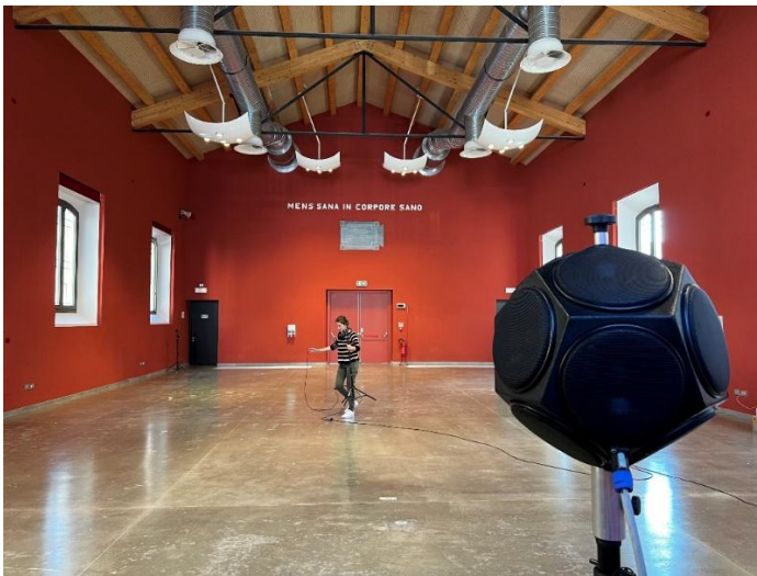
Figura 4 - Sala durante le misurazioni prima del trattamento acustico.
